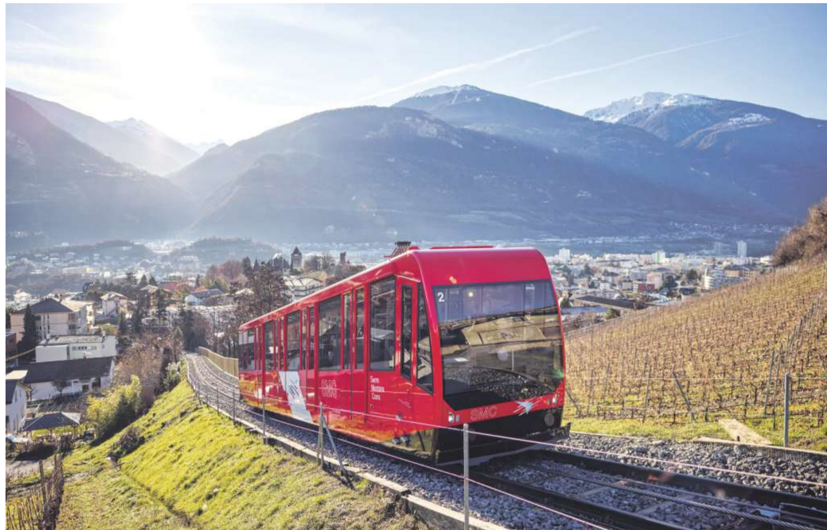
Die mit ABB-Komponenten ausgestattete Standseilbahn Sierre–Crans-Montana speichert Brems- und Solarenergie, um sie für den eigenen Betrieb zu nutzen. FOTOS: PD
